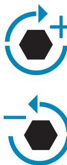
**Erhöhen der Federspannung - m Uhrzeigersinn anziehen**
