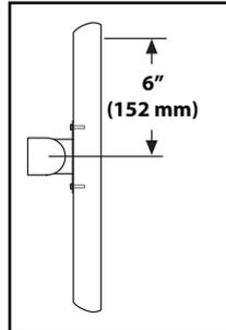
Bei der Bestimmung der Montagehöhe wird von einem Abstand von 152 mm (6") zwischen der Mitte der Monitormontagelöcher und der Oberkante des Bildschirms ausgegangen. Wenn der tatsächliche Abstand kleiner ist, sollten Sie die Montagehöhe entsprechend vergrößern; wenn er größer ist, sollten Sie ihn entsprechend verringern.
