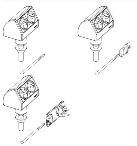
Festes Netzanschlusskabel unten aus dem Profil, Durchführung erfolgt durch den Edelstahlfuß. und ist
