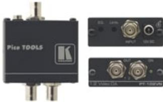
PT-102VN ist ein Composite- oder SDI-Video-Verteilverstärker. Er erhält ein Eingangssignal, entkoppelt und isoliert es und verteilt das Signal an zwei identische Ausgänge
