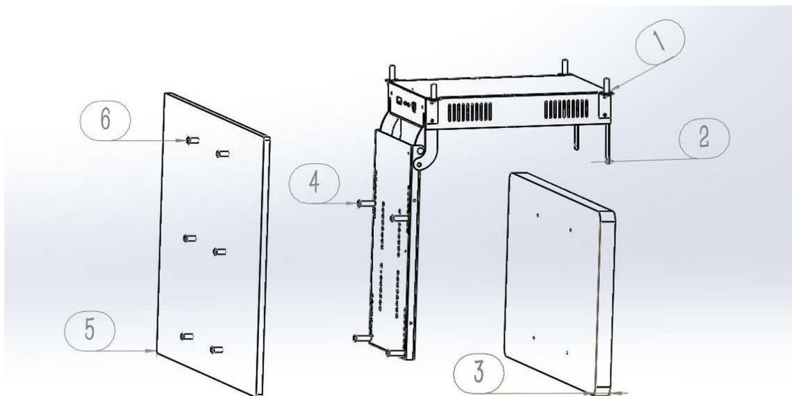
1. Montieren Sie den TV-Lift an der Decke mit 4 Expansionsschrauben
