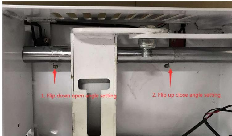
3. Lösen Sie die Einstellschrauben ein wenig (nicht vollständig!), bewegen diese um etwa 1 – 2 mm nach rechts und ziehen Sie sie wieder fest, vergrößert sich der Öffnungswinkel auf etwa 90 – 105°. Testen Sie das Herunterklappen erneut, um zu prüfen, ob der Winkel ausreicht.
