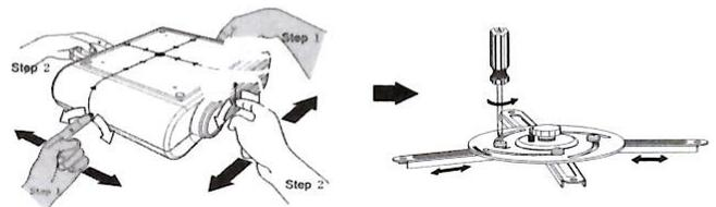
D) Montieren sie mit Hilfe der Abstandshalter den Beamer an der Befestigungsspinne.
