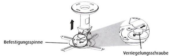
B) Befestigen sie die Halterung an der Decke mit geeignetem Montagmaterial. (Schrauben und Dübel nach Deckenart wählen !!)
