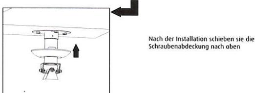
E) Montieren sie nun die Befestigungsspinne an der Deckenhalterung
