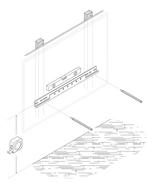
4. Bestimmen Sie die Höhe Ihres Anschlussadapters und markieren Sie die Bohrlöcher mithilfe der unteren horizontalen Leiste.
