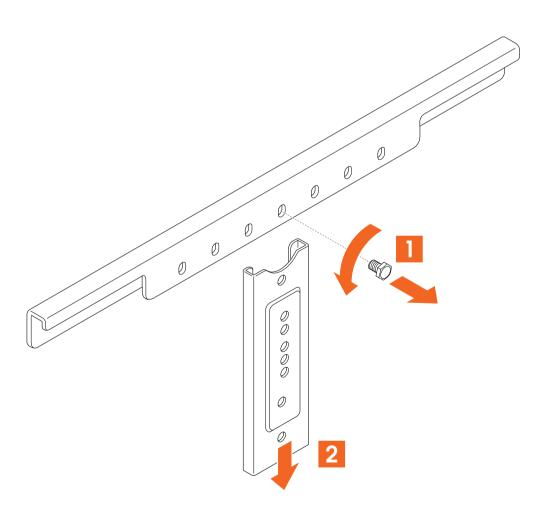
5. Lösen Sie den Bolzen, der die obere horizontale Stange mit der/den vertikalen Halterung(en) verbindet. Entfernen Sie die vertikale(n) Halterung(en).
