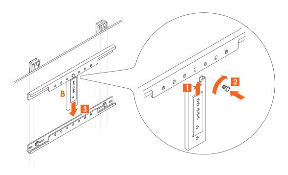
1. Befestigen Sie die obere horizontale Stange an der/den **vertikalen Halterung(en)** ®. Setzen Sie die zusammengebauten Teile vorübergehend in die untere horizontale Leiste ein.
