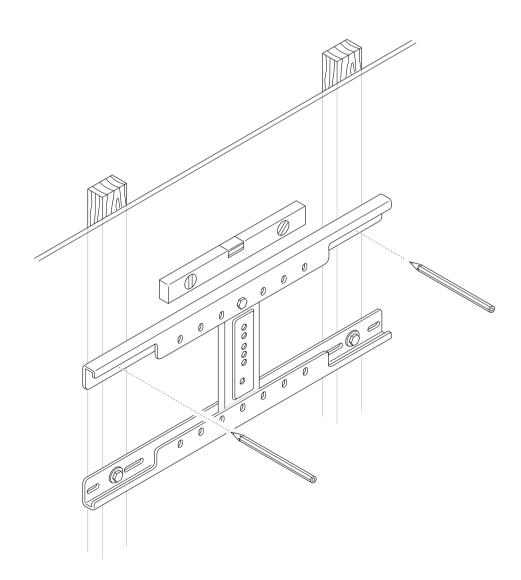
2. Verwenden Sie die Wasserwaage für eine waagerechte Montage der horizontalen Stange. Markieren Sie die Bohrlöcher
