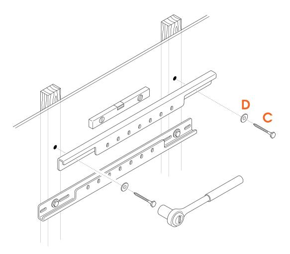
6. Befestigen Sie die obere horizontale Stange mit den **Schrauben** © und **Unterlegscheiben** © aus dem Montagesatz an der Wand.
