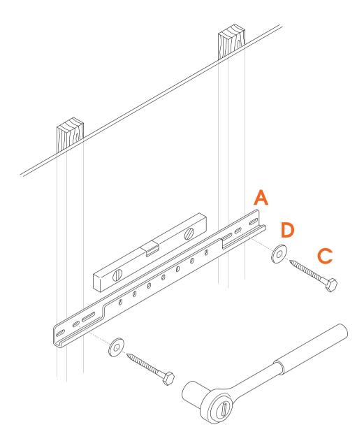
7. Befestigen Sie die untere **horizontale Stange** (A) mit den **Schrauben** (C) und **Unterlegscheiben** (D) aus dem Montagesatz an der Wand.
