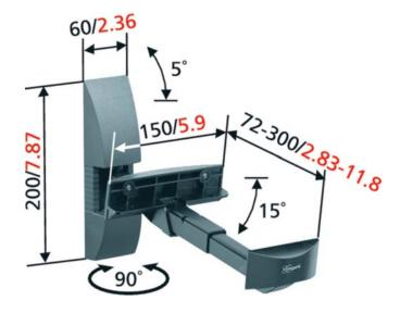
Die Klemmkonstruktion erlaubt eine schraubenlose Befestigung Ihres Lautsprechers. Die Neigungs- und Drehfunktion garantiert eine optimale Hörposition.
